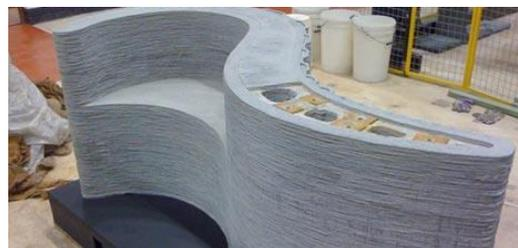
Рис. 4.3. – Изделия, напечатанные бетоном
