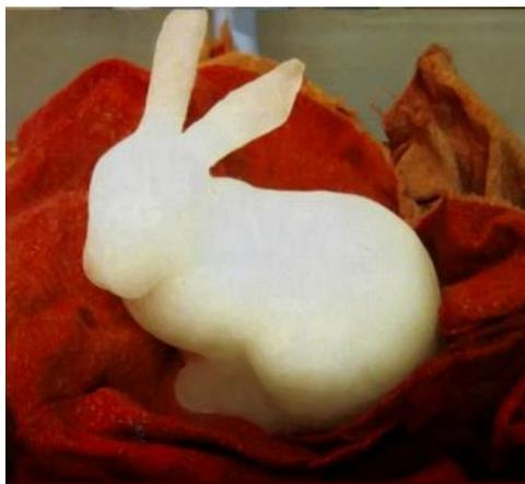
Рис. 4.8. – Фигура, напечатанная льдом
