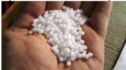
Рис. 4.12. – Поликапролактон для 3D принтера
