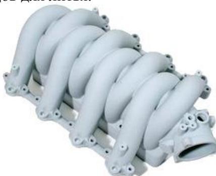
Рис. 4.6. – 3D модель, напечатанная из гипса
