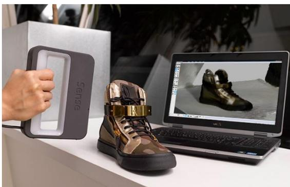
Рис. 2.2. – Пример работы с ручным 3D сканером
