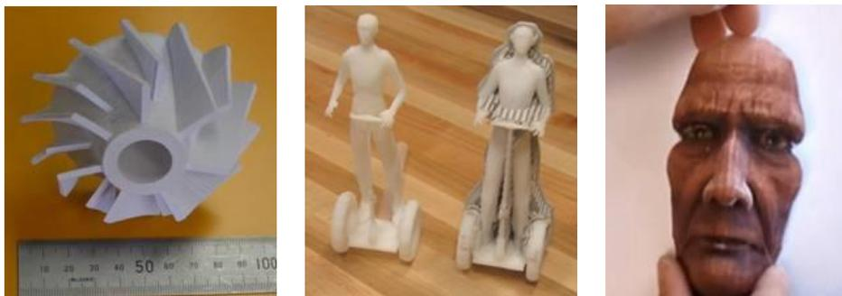
Рис. 4.5. – 3D модели, напечатанные из бумаги
